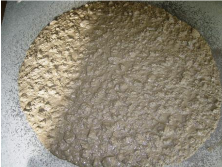
C25/30 Standard Ausbreitmaß 510 mm
