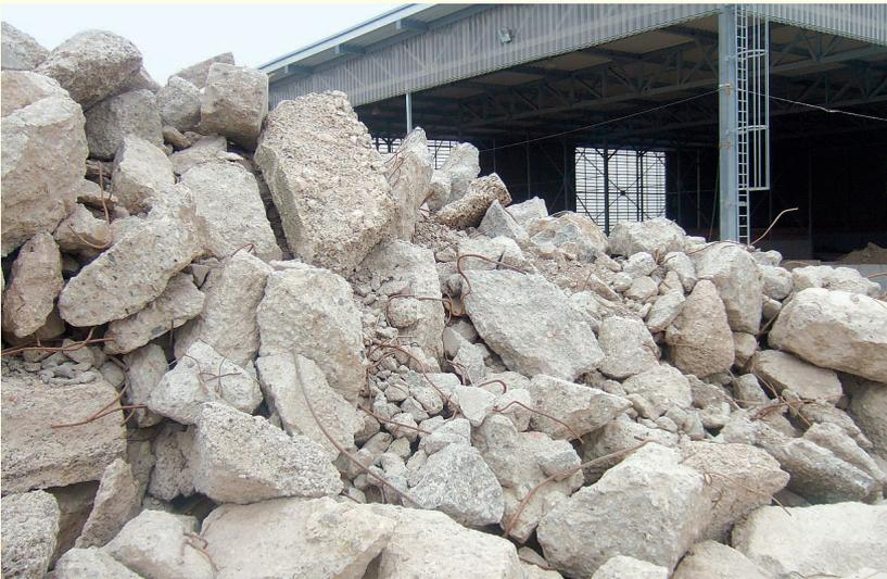
Um im Ansatz definierte reproduzierbare Mischungen nach Liefertyp 2 sicherzustellen, bedarf es einer getrennten Aufbereitung der beiden Stoffströme Altbeton und Mauerwerksbruch.
