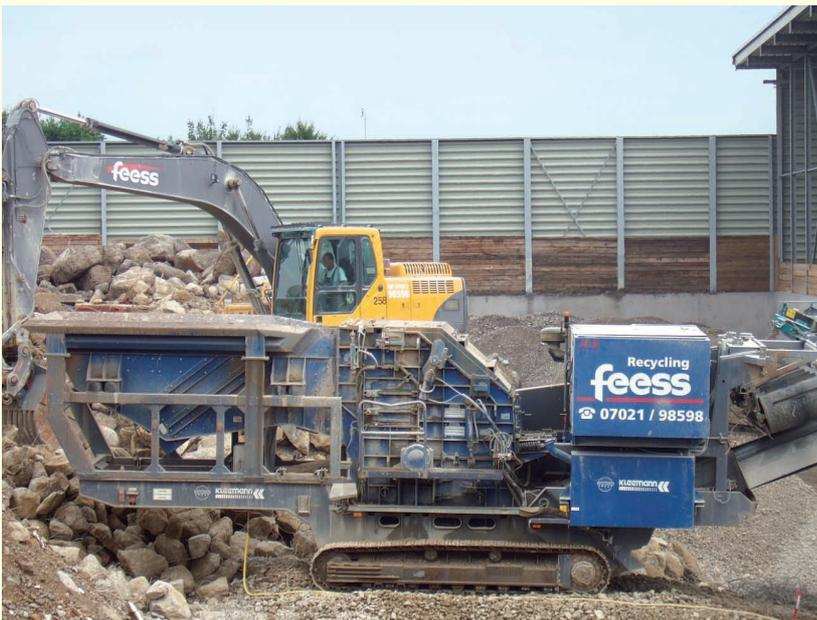
Für den Einsatz im R-Beton muss die RC-Gesteinskörnung  $> 2$  mm sein. Deshalb muss nach dieser Zerkleinerung zwingend eine Abtrennung der Feinfraktion bzw. des Brechsandes erfolgen.
